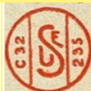
1957 USE-Kennzeichnung gedruckt mit Standardnummer (C32) und Herstelleridentifikationsnummer (295)
