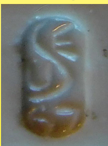
1932 USE-Kennzeichnung auf Maure-Reihenklemmen aus Porzellan
