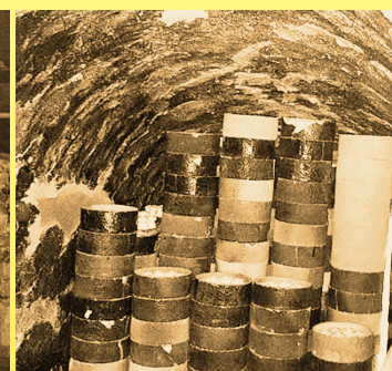
Traditionell chinesischer Drachen-Töpferofen (chinesisch 龙窑 lung-yao), Öffnung zum Beladen und Stapelmethode mit Elektroporzellan (Privatsammlung)
