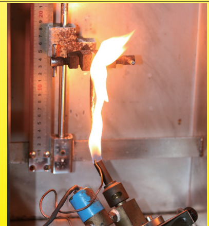
Prüflinge während der Prüfung laut UL94 V-0
